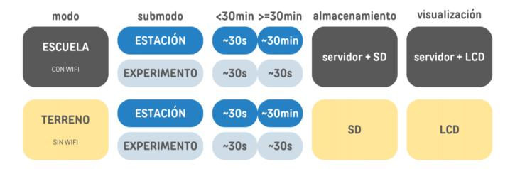
7. La EMA ya está operativa y midiendo. Los datos y la frecuencia de medición se almacenarán según la figura anterior.
